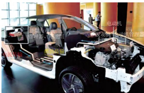
图 2-30 比亚迪秦混合动力汽车的动力电池安装位置
