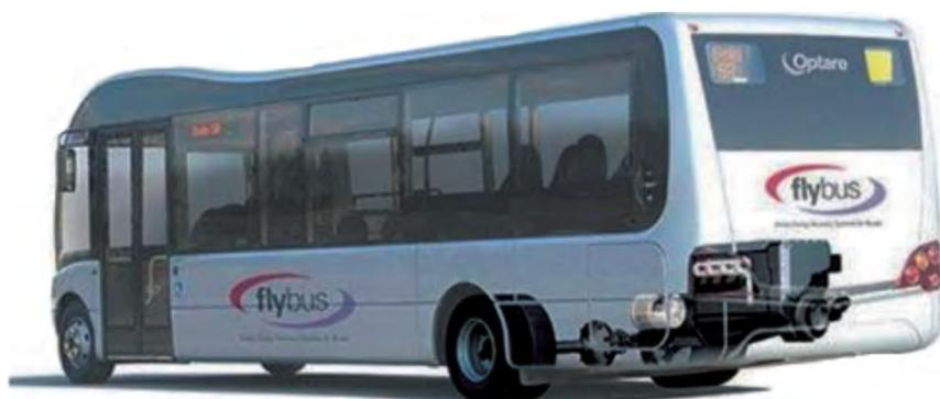
图 2-37 飞轮蓄能装置的混合动力汽车
