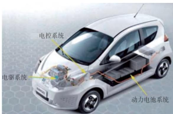
图 2-31 荣威 E50 纯电动汽车的动力电池安装位置
