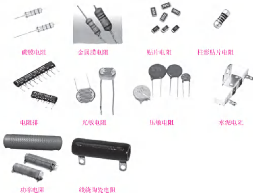
图 1-6 常用固定电阻器外形
