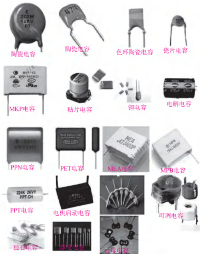
图 1-12 常用电容器的外形
