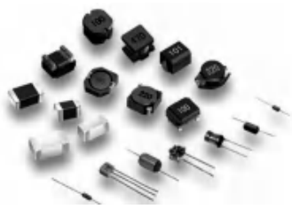
图 1-15 常用电感器的外形
