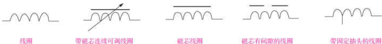
图 1-14 电感线圈的图形符号
