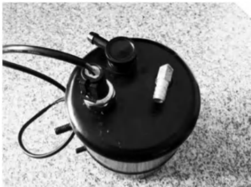
图 1-5-3 真空罐 (电线插头位置为真空压力传感器)
