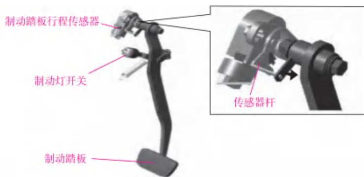
图 1-5-7 制动踏板行程传感器
