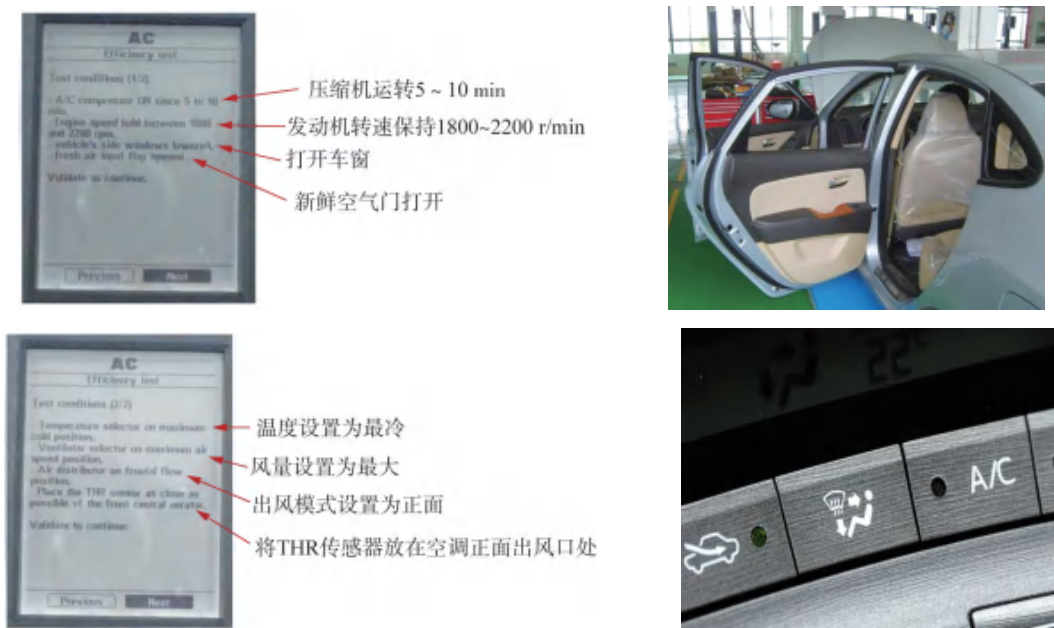
图 2-35 空调性能检测
