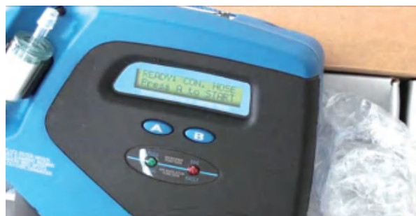
图 2-14 系统标定——接入采样管
