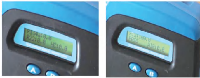
图 2-16 制冷剂的种类和空气污染程度显示
