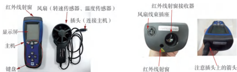
图 2-50 风速计的结构
