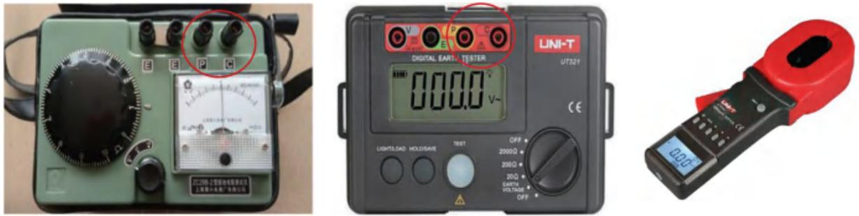
图 3.4-1 接地电阻测试仪的种类
