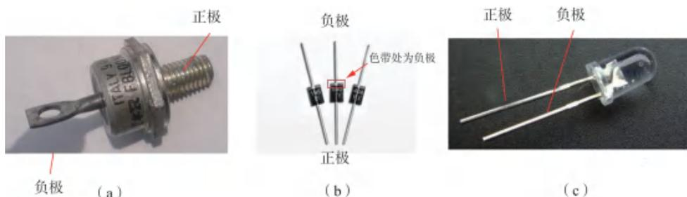
图 3.1-12 二极管引脚的极性
