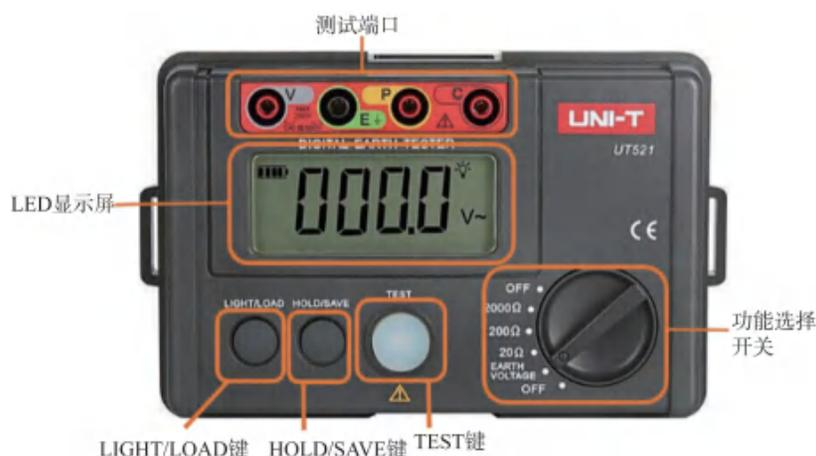
图 3.4-3 优利德数字式接地电阻测试仪
