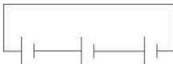
图 1.6-6 三个电池的串联
