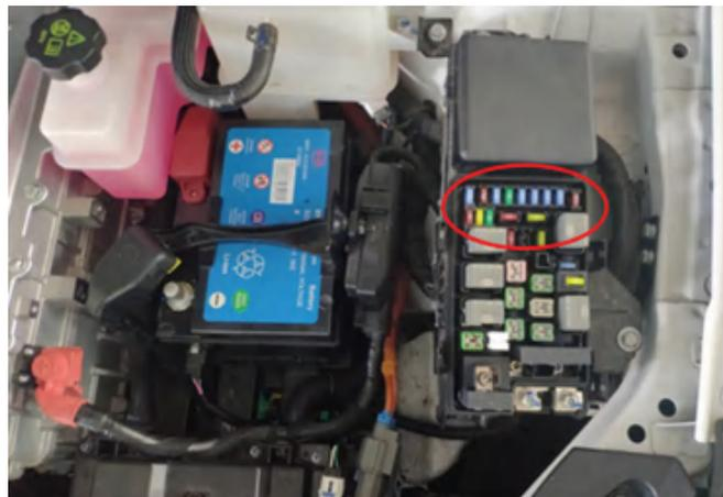
图 2.3-4 安装在蓄电池附近的熔断器
