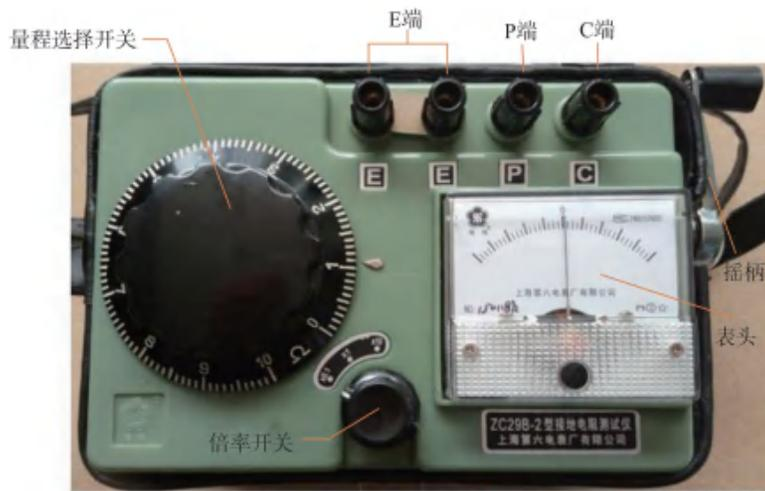
图 3.4-2 接地电阻测试仪
