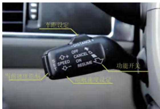
图 2-42 ACC 操作在方向盘的位置
