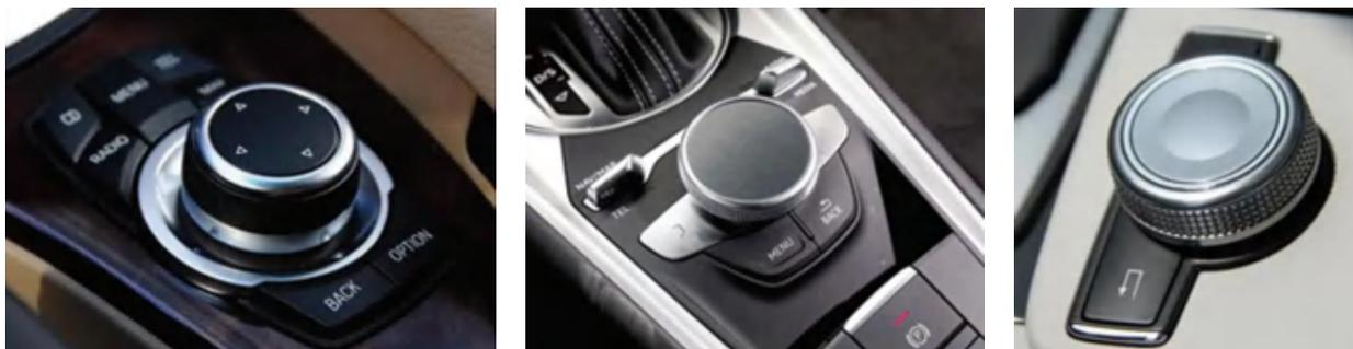
图 2-19 iDrive、MMI、Command 的多功能旋钮
