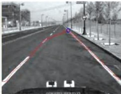
图 2-26 车道线的灰度图像
