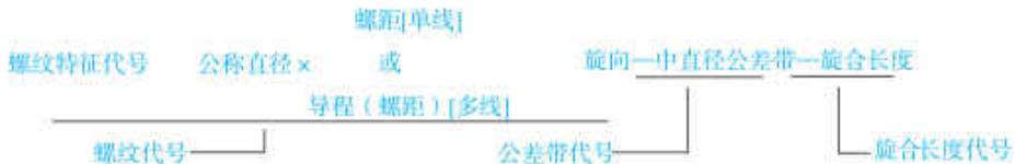
梯形螺纹的牙型角为 30°，牙型代号为“Tr”。单线螺纹用“公称直径×螺距”表示；多线螺纹用“公称直径×导程(P 螺距)”表示。当螺纹为左旋时，标注“LH”，右旋省略不标。其公差带代号只标注中径的，旋合长度只分中旋合长度和长旋合长度两种。标注如下：
