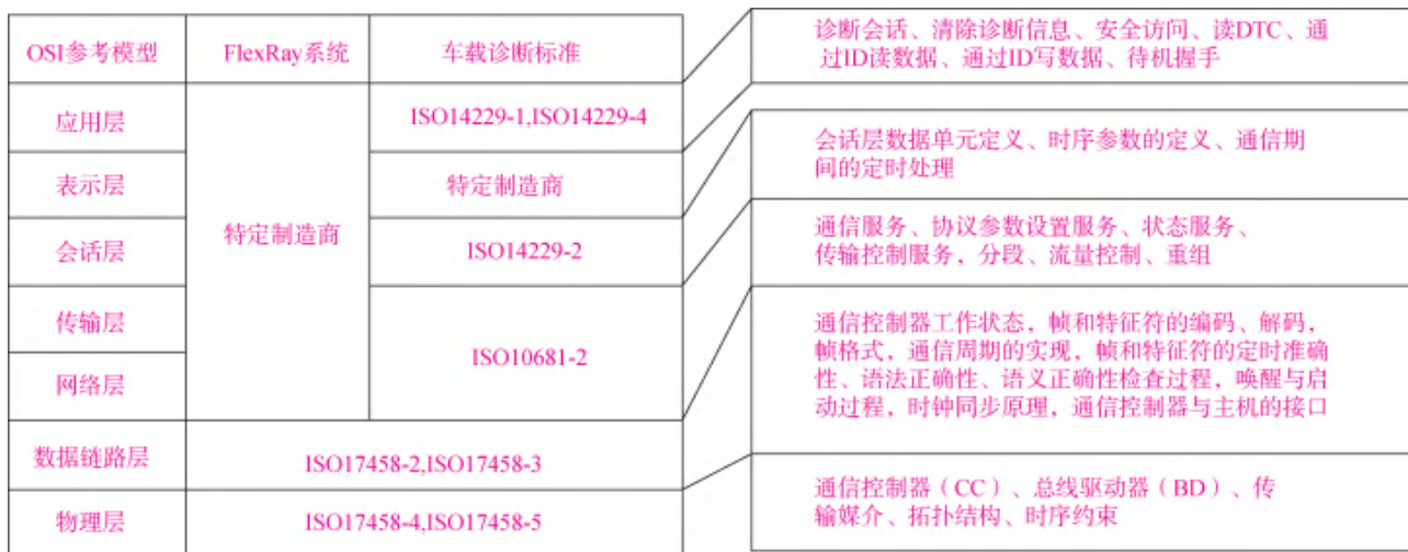
图 5-36 FlexRay 的分层结构
