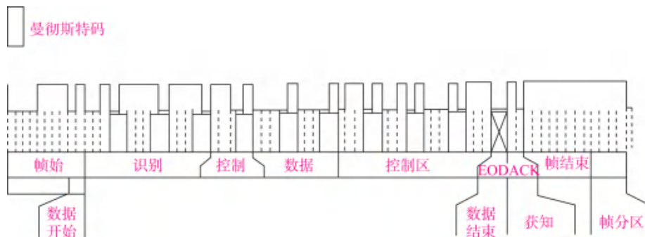
图 5-22 VAN 总线的帧结构
