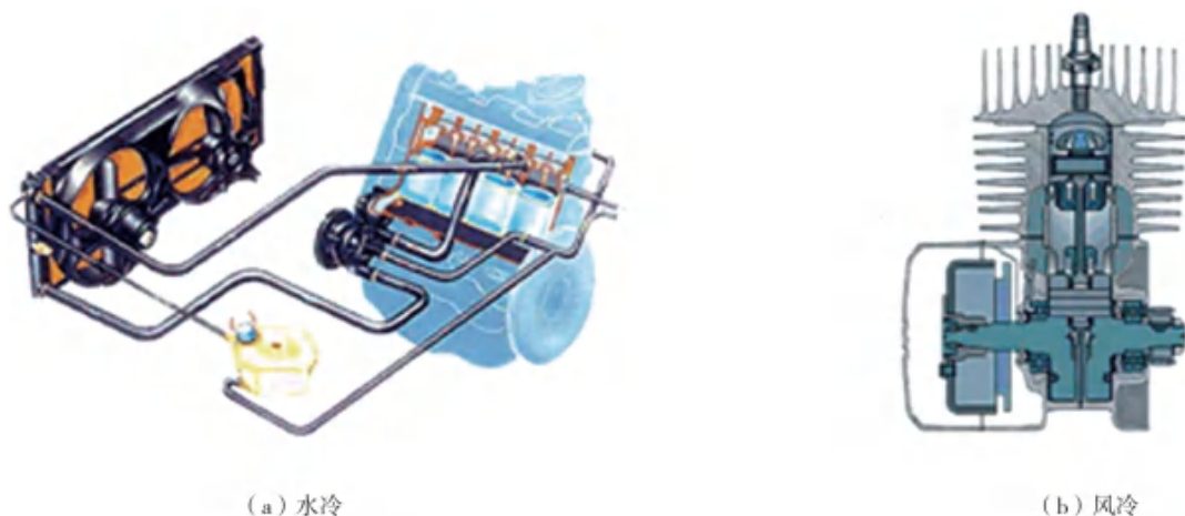
图 1.2 发动机按照冷却方式分类
