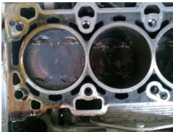
图 2-1-2 气缸活塞顶部靠近进气侧的和气门干涉的痕迹
