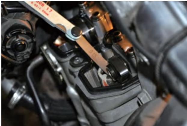
图 2-1-1 检查气门间隙
