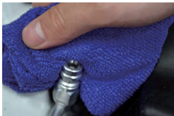
图 2-10 清洁检漏仪探头及加注阀芯
