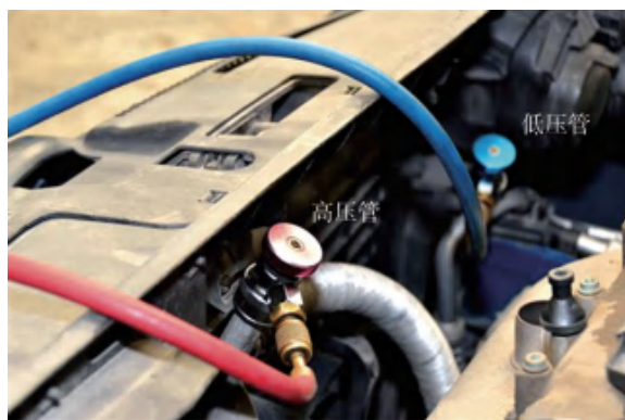
图 2-23 汽车空调系统高、低压管路位置图
