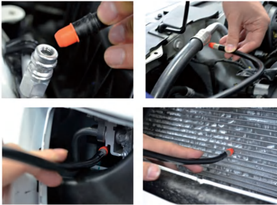
图 2-12 空调系统检漏步骤
