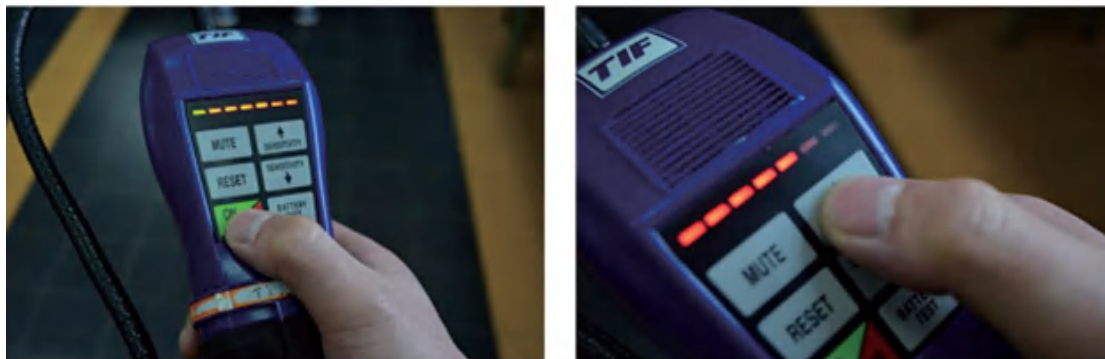
图 2-11 调节电子卤素检漏仪灵敏度
