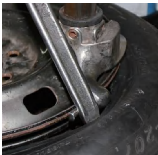
(10) 用撬杠将胎缘撬在拆装头前端半球形突起以上
