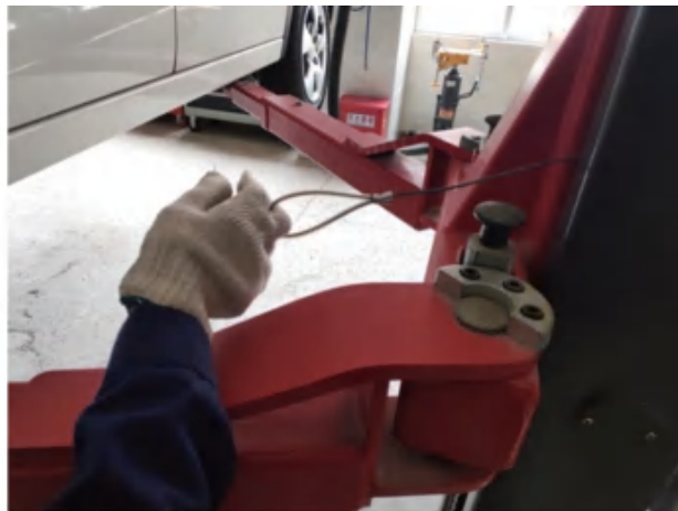
(5) 下降车辆，需先上升一点车辆再拉开两边保险
