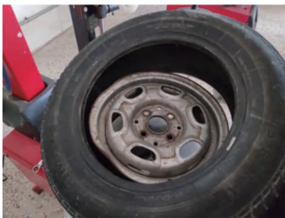
(12) 将第二层轮胎边缘拆出
