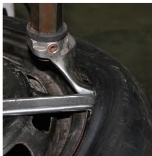
(10) 用撬杠将胎缘撬在拆装头前端半球形突起以上
