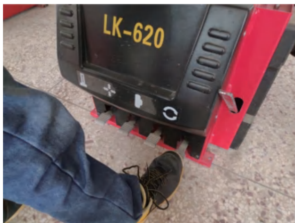
(11) 让转盘顺时针旋转，直到胎缘脱落为止
