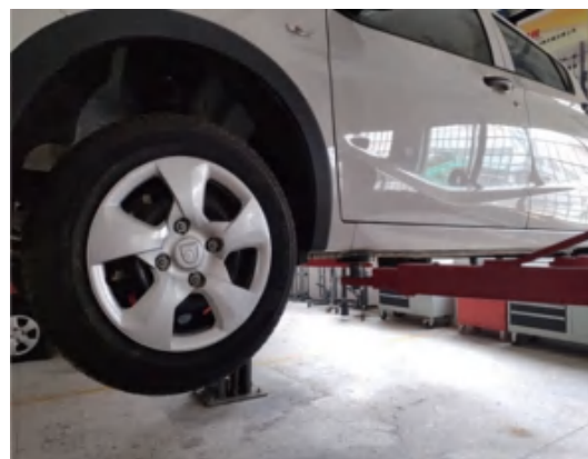
(4) 举升机上升到安全的位置
