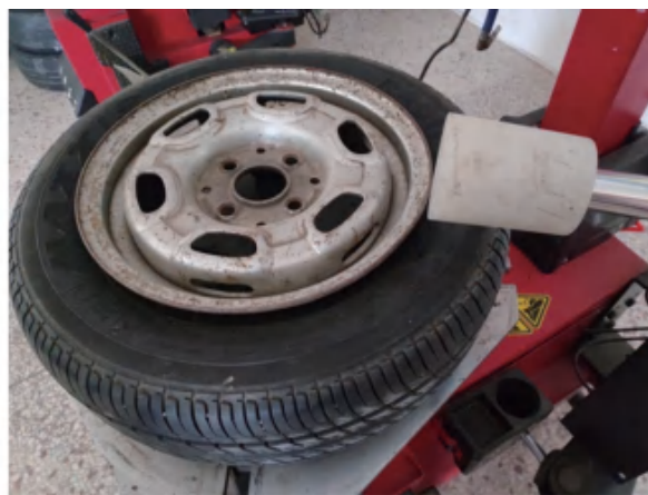
(11) 让转盘顺时针旋转，直到胎缘脱落为止
