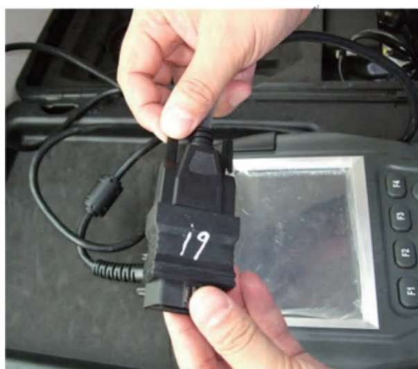
(8) 锁紧连接插口与诊断插口
