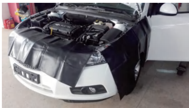
(4) 铺好后的整体防护情况
