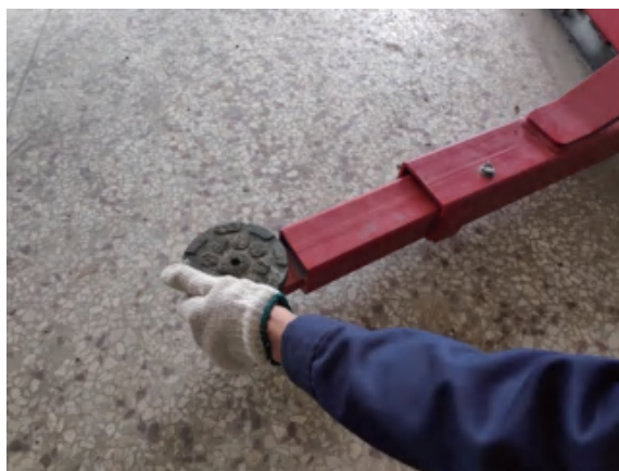
(7) 安全落地后，收回支撑臂
