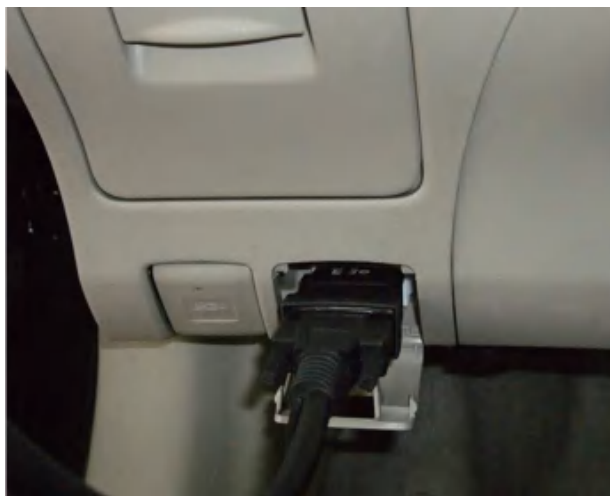
(12) 固定好 OBD 插口的连接
