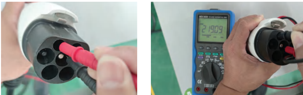
图 4-3-9 充电枪 CC-PE 间的阻值测量
